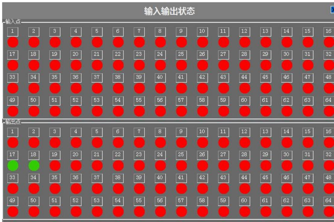
图示部分为输入输出差点的实时状态，绿色表示为有输入或者有输出状态，红色表示无输入或无输出状态，此处可具体观察每个输入输出点的实时状态。
