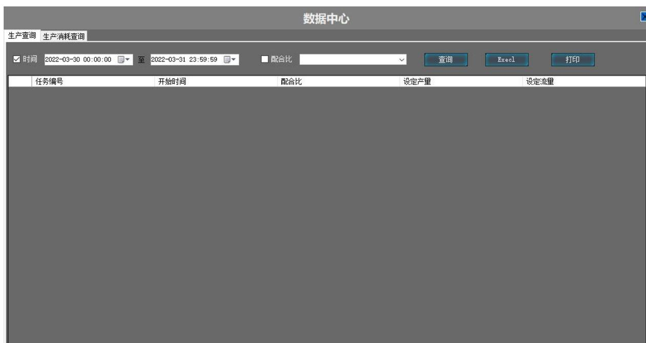
【数据中心】中为如图所示界面，可以按照时间或者配合比查询任务，或者查询原料消耗。按照时间或者配合比查询，只需要勾选即可，可转换成 Execl 表格,也可打印。
