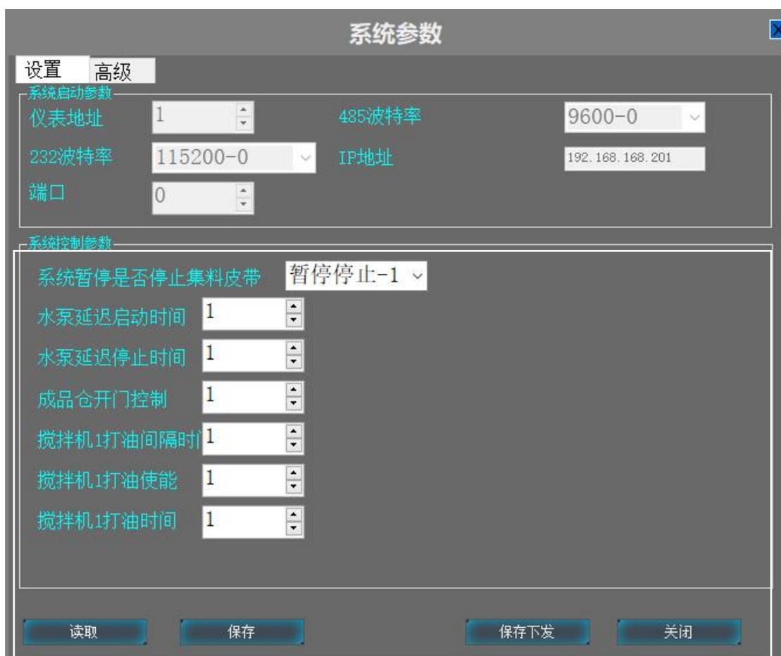
**系统启动参数：**可更改仪表地址，485，232 波特率，IP 地址和端口；一般无需更改。
