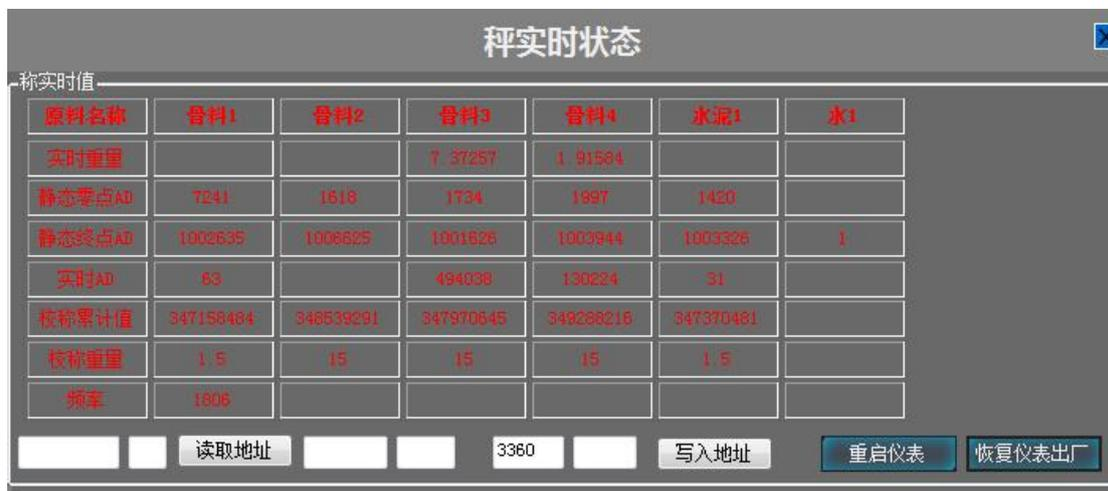
图示部分显示为每一个秤的实时重量，实时 AD 值，实时频率等参数。
