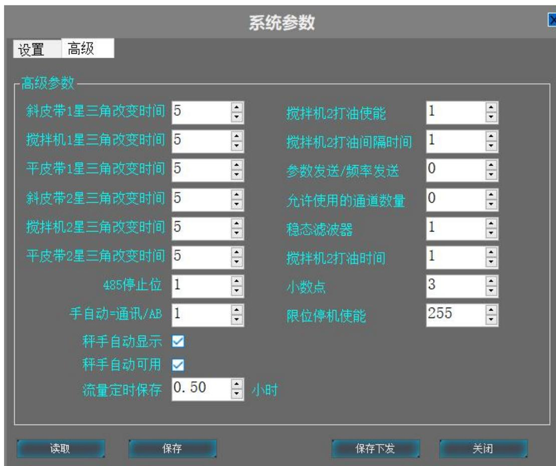
上图所示中，可调节斜皮带 1、2 平皮带 1、2 搅拌机 1、2 星三角的改变时间。
